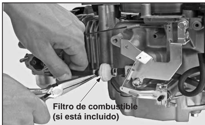
Figura 5. Filtro de combustible (filtro de aire desmontado).
