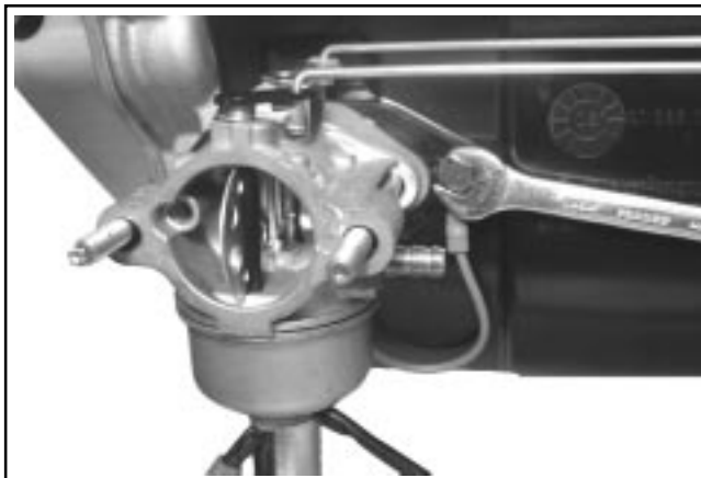
Figure 8-13. Dépose de la vis du déflecteur thermique et du câble de masse.
