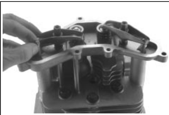
Figure 10-38. Installation des poussoirs et des culbuteurs.
