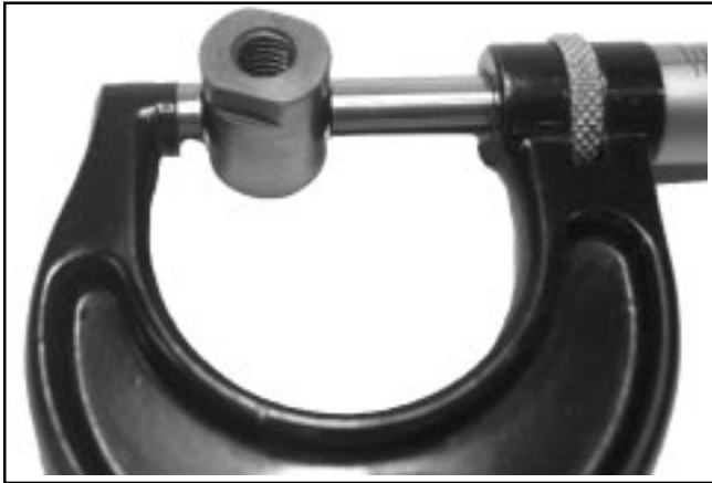
Figure 9-8. Mesure du diamètre extérieur de la goupille de guidage.
