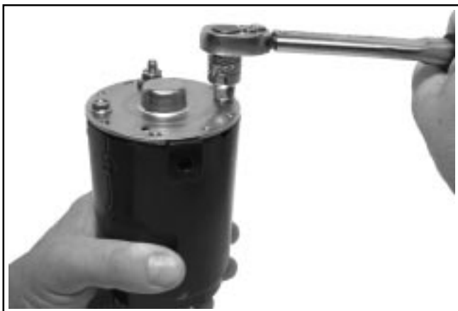
Figure 7-22. Serrage des boulons.
