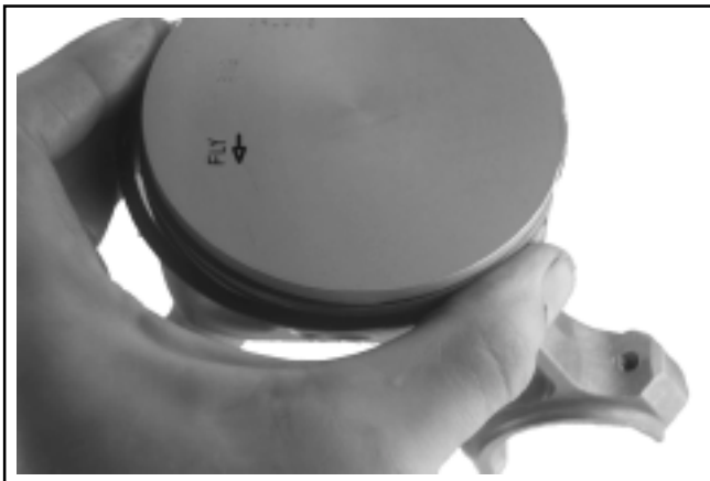
Figure 10-17. Flèche de direction sur le piston.
