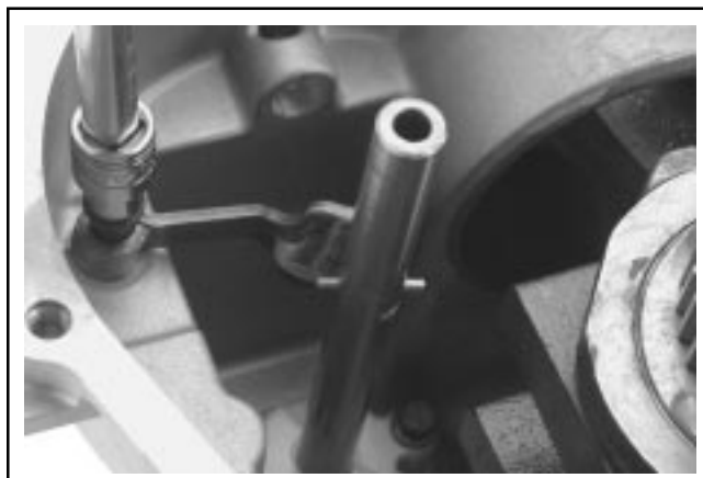
Figure 8-40. Dépose des leviers à cames.
