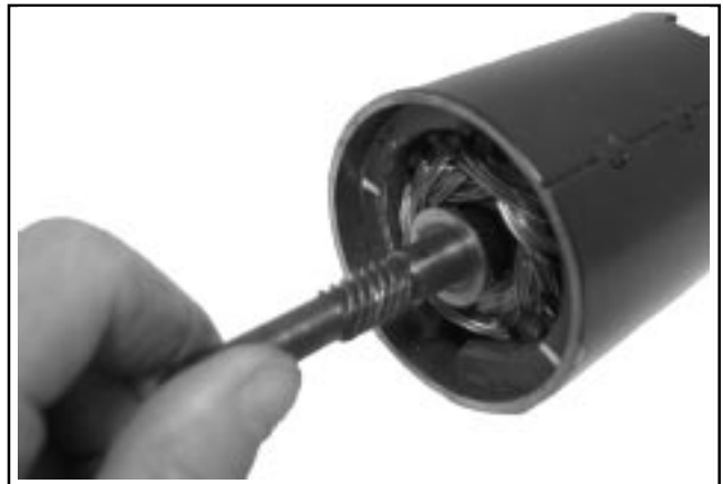
Figure 7-19. Armature installée dans le corps de démarreur.
