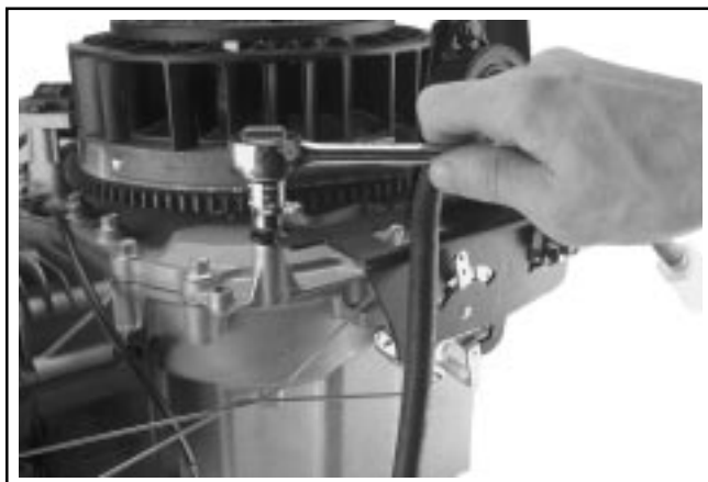
Figure 8-16. Dépose de la console de commande de la vitesse de la plaque de fermeture.
