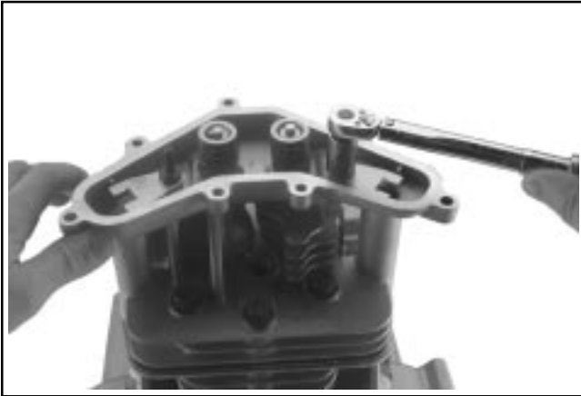
Figure 10-37. Installation des plaques de guidage et des goujons de pivot du culbuteur.
