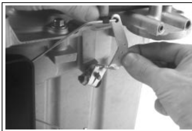
Figure 10-63. Levier du régulateur installé sur l'arbre.
