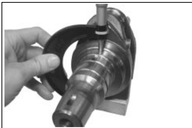
Figure 9-5. Mesure de l'excentrique du vilebrequin.
