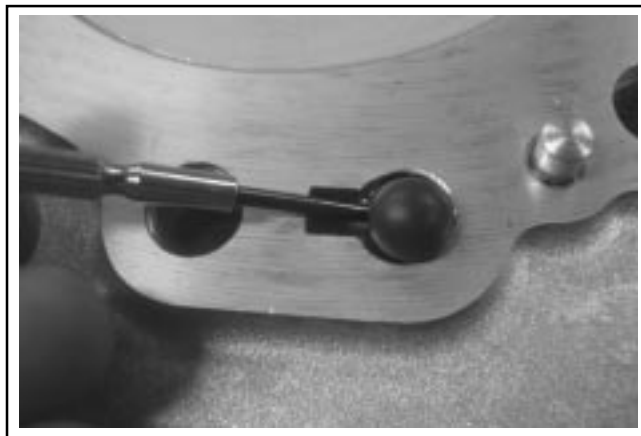
Figure 8-31. Dépose du drain du carter.
