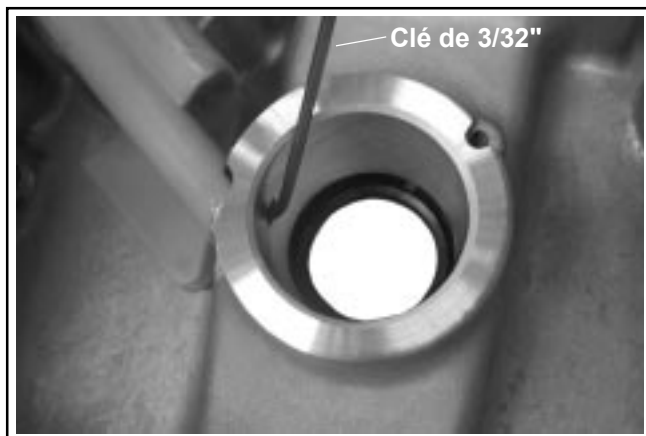
Figure 10-10. Contrôle de l'ouverture du passage du joint extérieur (style ouvert).
