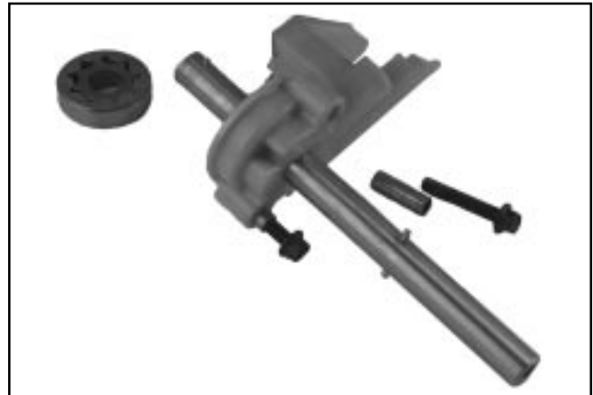
Figure 6-7. Pompe à huile sur arbre à cames d'admission (Gerotor retiré du carter de pompe).
