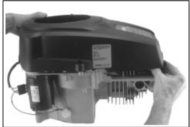
Figure 10-70. Installation du carter du ventilateur.
