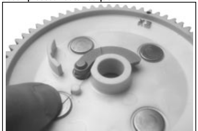
Figure 10-24. Accrocher le ressort du décompresseur automatique sur l'engrenage à cames côté échappement.
