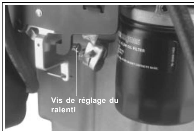
Figure 5-19. Emplacement de la vis de réglage du ralenti.
