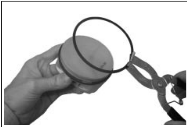
Figure 8-47. Dépose des segments de piston.
