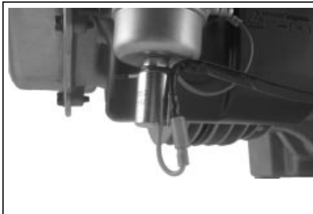
Figure 10-57. Câble du solénoïde de carburant attaché par un collier de serrage.
