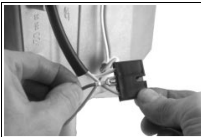
Figure 10-43. Installation du câble B+ sur le connecteur.
