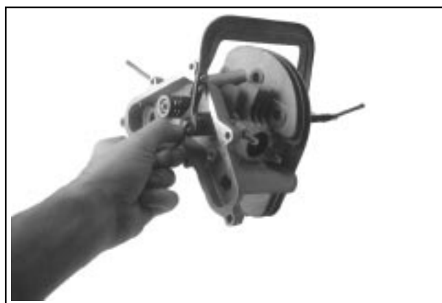
Figure 10-32. Assemblage de la culasse.
