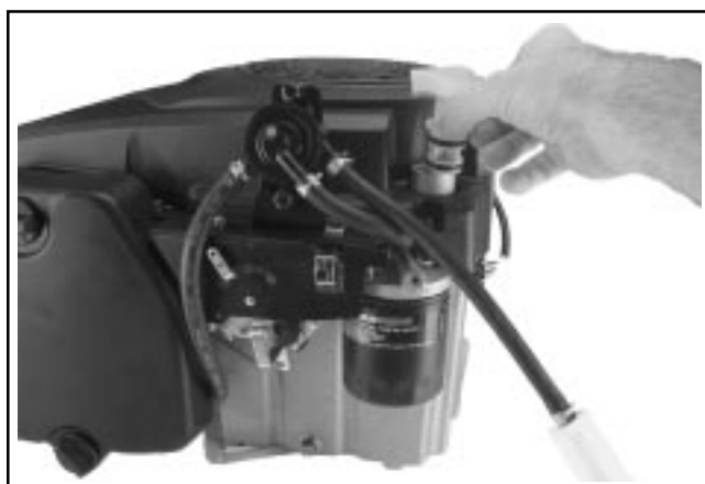
Figure 8-1. Emplacements du bouchon de vidange, du filtre à huile et du bouchon de remplissage/de la jauge.
