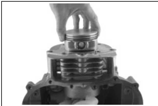
Figure 8-45. Dépose du piston et de la bielle.
