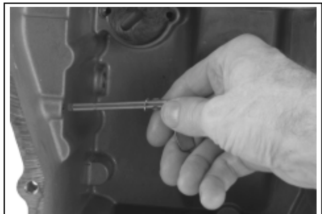
Figure 8-53. Dépose de l'arbre intermédiaire du régulateur.
