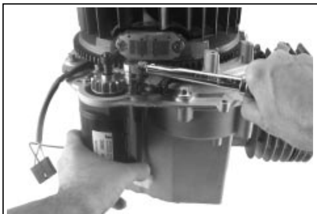
Figure 10-47. Installation du démarreur électrique.
