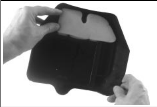
Figure 10-76. Installation du pré-filtre.
