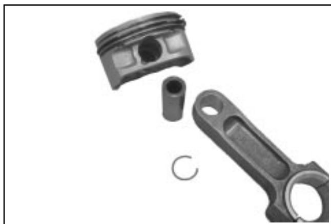
Figure 8-46. Séparation du piston de la bielle.
