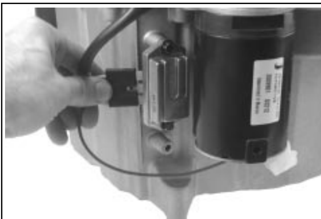
Figure 10-69. Installation du redresseur-régulateur.
