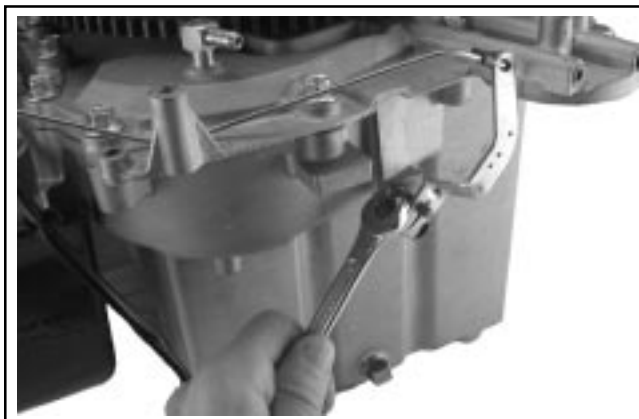
Figure 8-18. Dépose du levier du régulateur.
