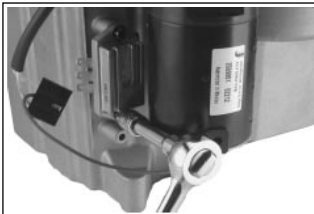
Figure 8-5. Dépose du redresseur-régulateur.
