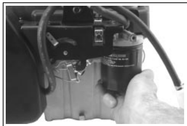
Figure 10-79. Installation du filtre à huile.
