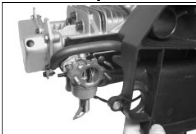
Figure 8-10. Dépose de la base du filtre à air et du tube reniflard.
