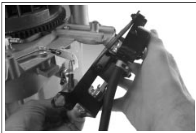
Figure 8-17. Déconnexion du ressort du régulateur.
