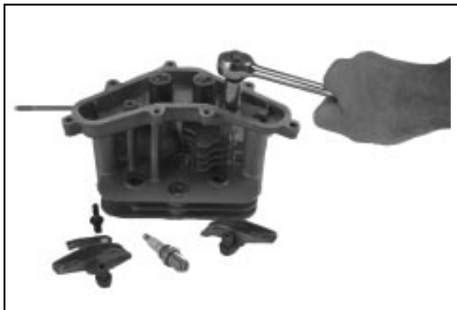
Figure 8-33. Démontage des composants du culbuteur.
