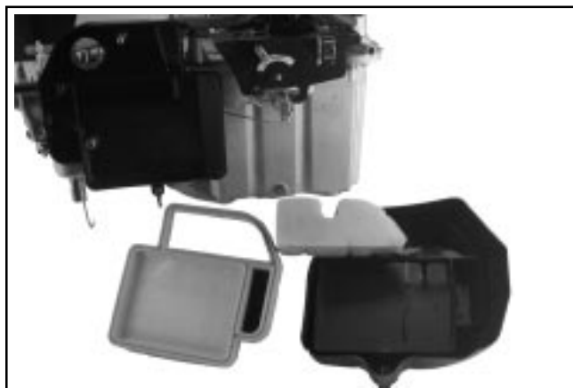
Figure 8-8. Dépose des composants du filtre à air.
