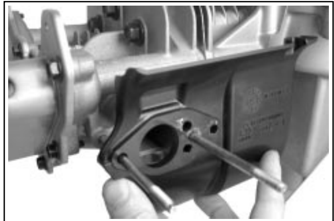
Figure 10-53. Installation du joint d'admission et du déflecteur thermique.
