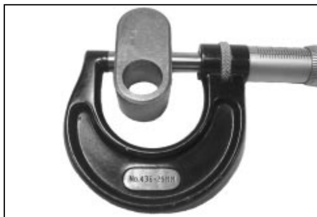
Figure 9-6. Mesure du sabot de guidage de la masselotte.
