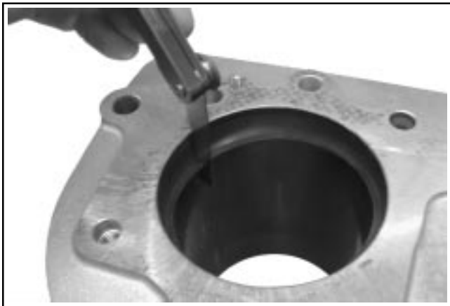
Figure 9-13. Mesure de la coupe du segment de piston.
