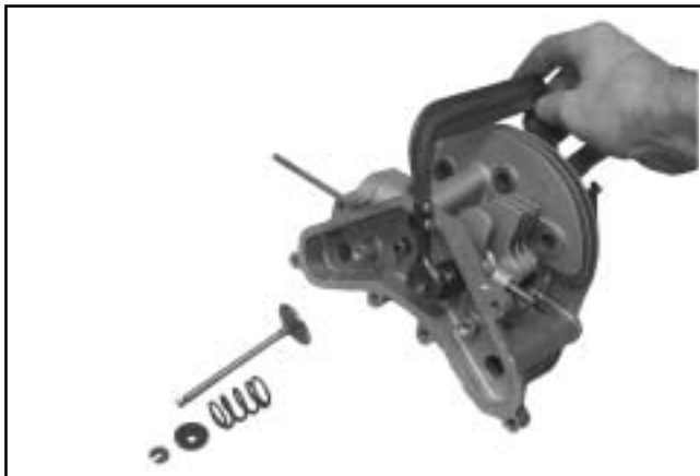
Figur 8-34. ta av ventiler med fjærkompressor.
