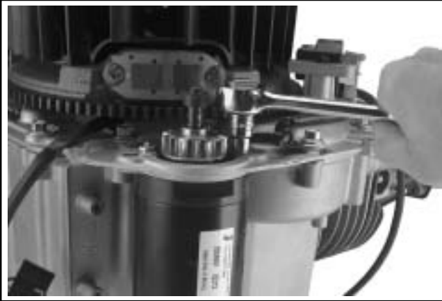
Figur 8-6. Ta av elektrisk starter.
