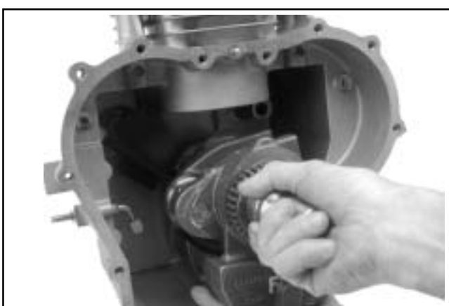
Figur 8-48. Ta av veivaksel og motvektenhet.
