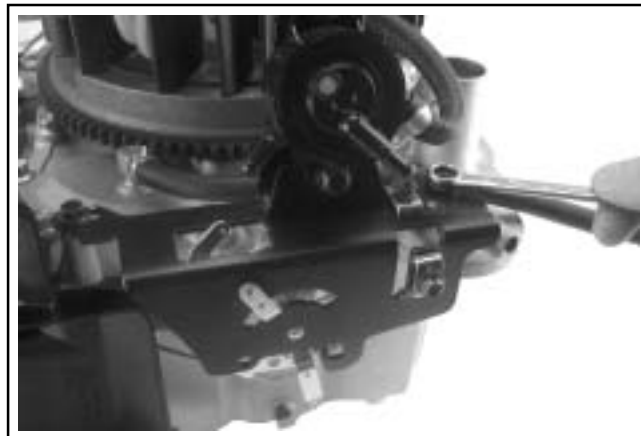
Figur 10-66. Sette på hastighetskontrollbrakett.
