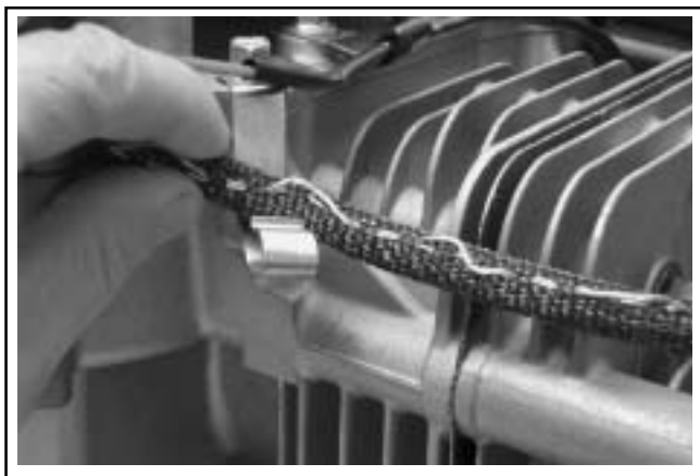
Figur 8-20. Fjerne leder fra klemme (enheter utstyrt med støyskjerming).
