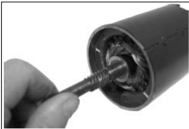
Figur 7-19. Armatur installert i starterramme.
