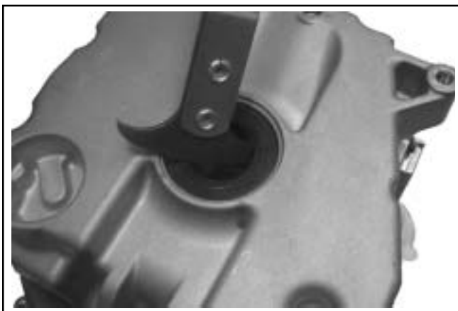
Figur 8-54. Fjerne pakning med pakningsavtrekker.
