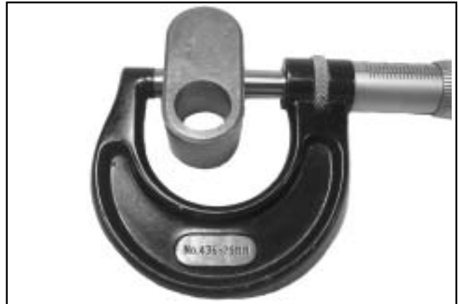
Figur 9-6. Måle motvektens føringsско.
