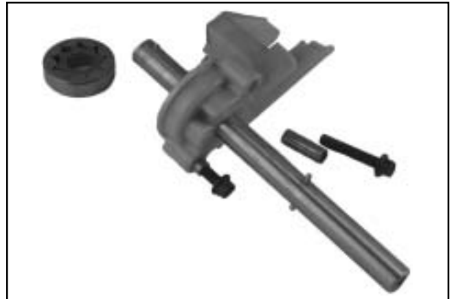
Figur 6-7. Oljepumpe på inntakskamaksel (Gerotorer fjernes fra pumpehus).
