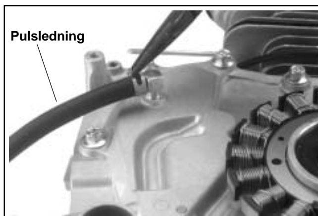
Figur 10-44. Kople pulsledning til rørdel.
