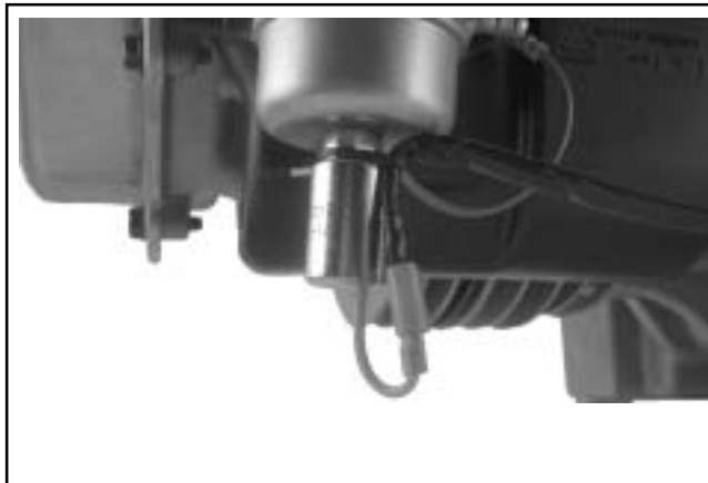
Figur 10-57. Drivstoffsolenoidledning festet med plaststropp.
