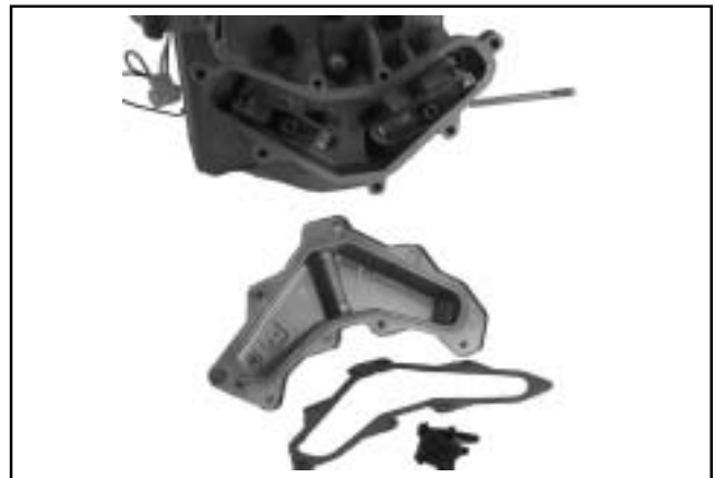
Figur 8-27. Ventildeksel og pakningsdetaljer.
