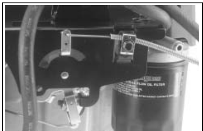
Figur 5-12. Hastighetskontrollbrakett med felles gass/chokekontroll.
