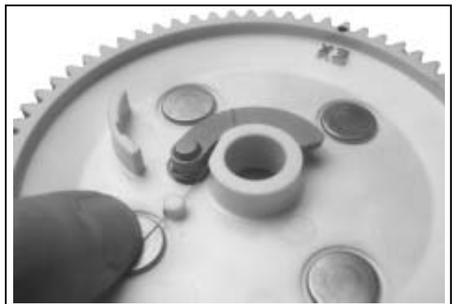
Figur 10-24. Hekte ACR-fjær på eksoskamdrev.
