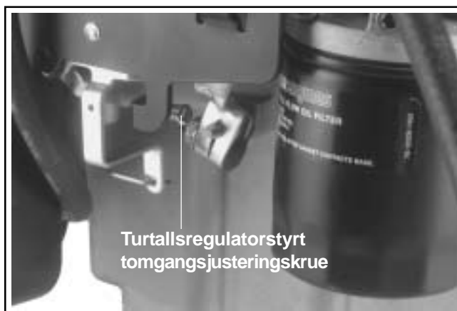
Figur 5-19. Plassering av turtallsregulatorstyrt tomgangsjusteringsskruen.
