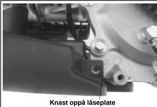
Figur 10-59. Detaljer ved øvre festeknast for luftfilterets holder.
