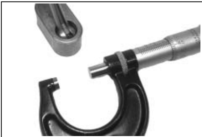
Figur 9-9. Måle føringssskoens innvendige diameter.
