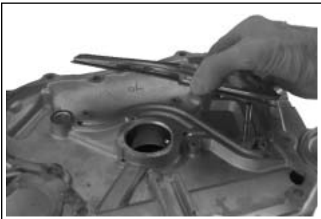
Figur 8-38. Fjerne oljepassasjedekselet og pakningen.
