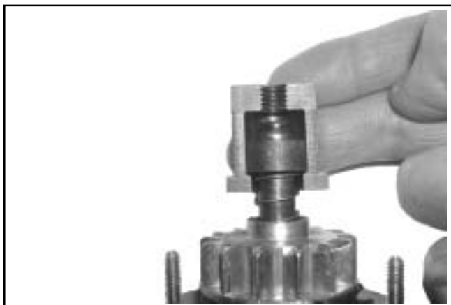
Figur 7-15. Sette sammen større indre halvdel rundt fjærholder.
