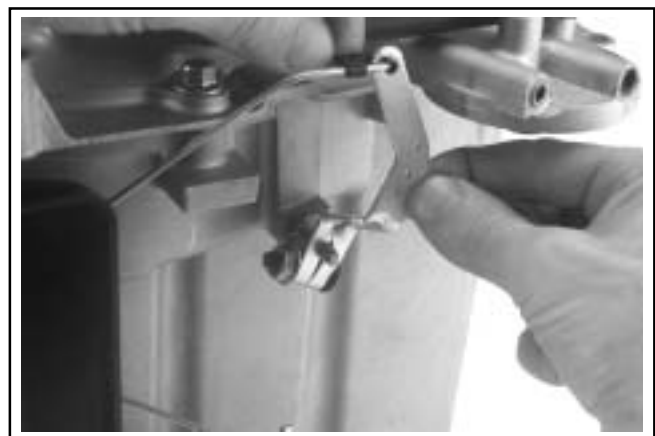
Figur 10-63. Turtallsregulatorspak installert på aksel.
