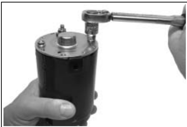
Figur 7-22. Tiltrekking av gjennomgående bolter.
