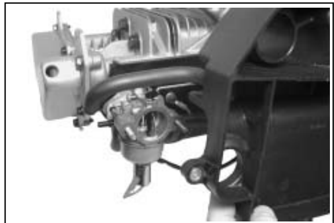
Figur 8-10. Ta av luftfilterholder og lufteslange.
