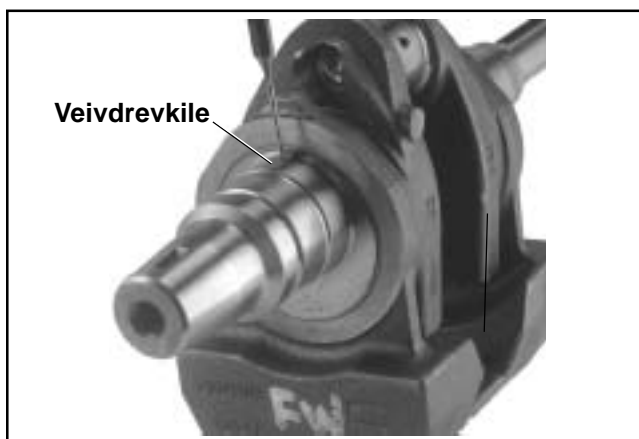
Figur 10-13. Installere veivdrevets kile.
