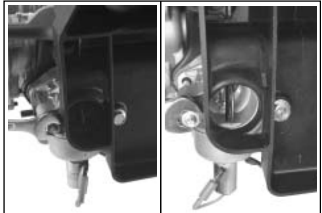
Figur 8-9. Ta av luftfilterholderens festelementer.
