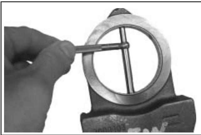
Figur 9-4. Måle motvektens lagerflate.
