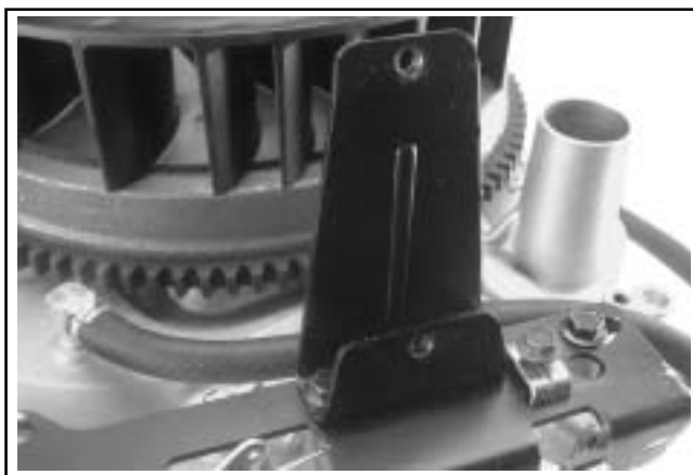
Figur 10-67. Installere drivstoffpumpens festebrakett.
