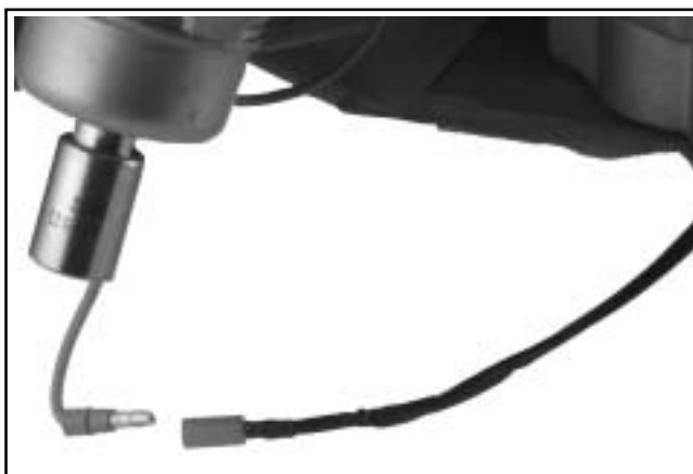
Figur 8-14. Kople fra drivstoffsolenoidens ledning.
