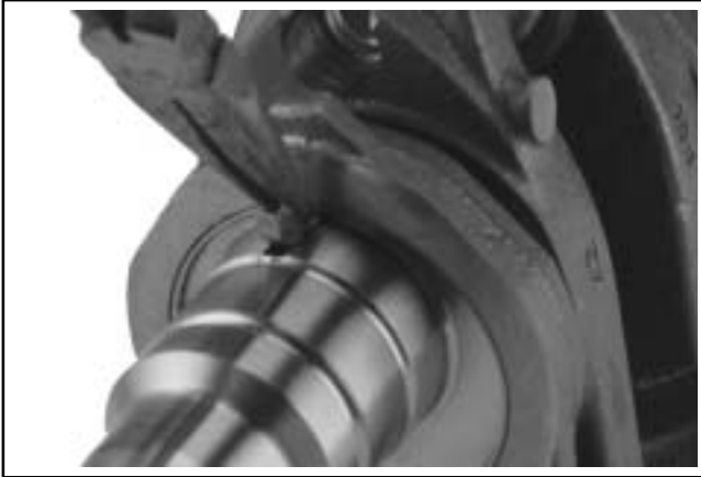
Figur 8-49. Ta av veivdrevets kile.
