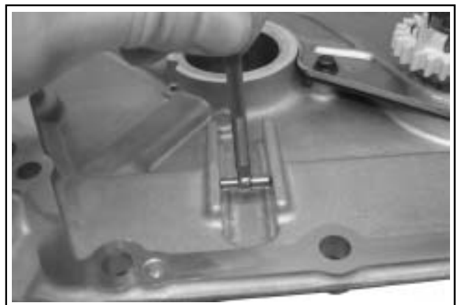
Figur 9-7. Måle styrekanal i låseplate.
