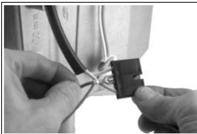
Figur 10-43. Installere leder B+ i kontakten.
