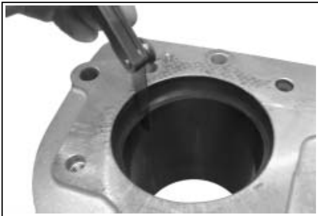
Figur 9-13. Måle stempelringens endespalte.
