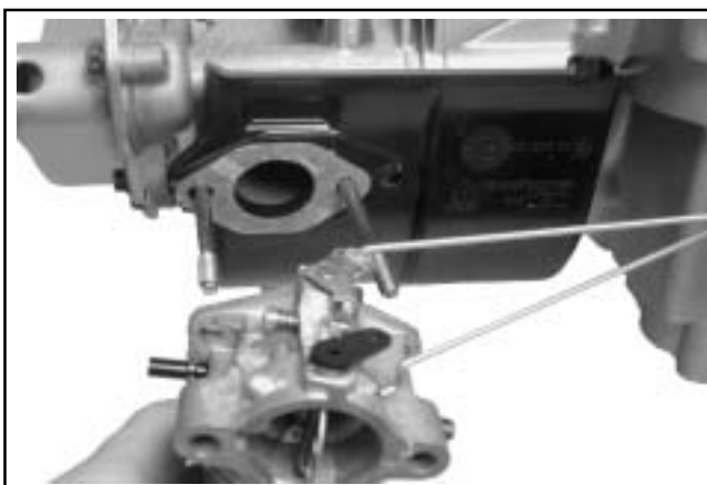
Figur 8-15. Ta av forgasseren.
