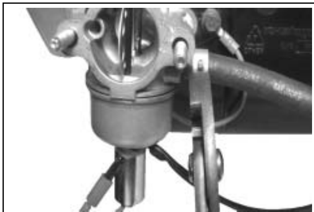
Figur 8-11. Kople drivstoffledningen fra forgasseren.
