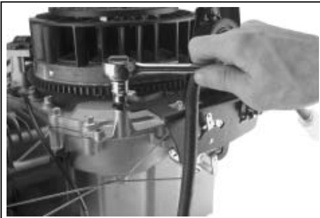
Figur 8-16. Fjerne hastighetskontrollbraketten fra låseplaten.
