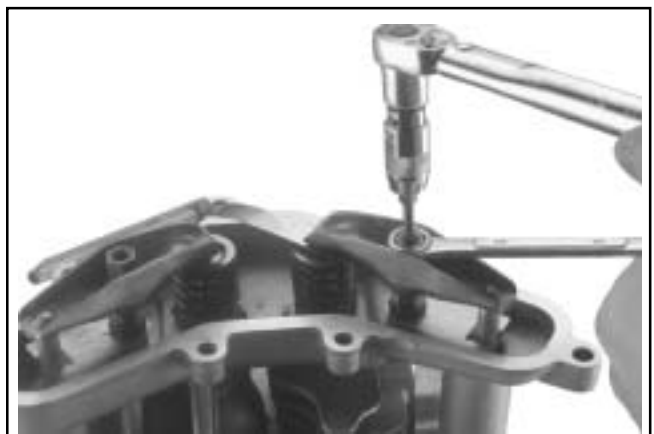
Figur 10-40. Låse justeringsmutterens settskruen.
