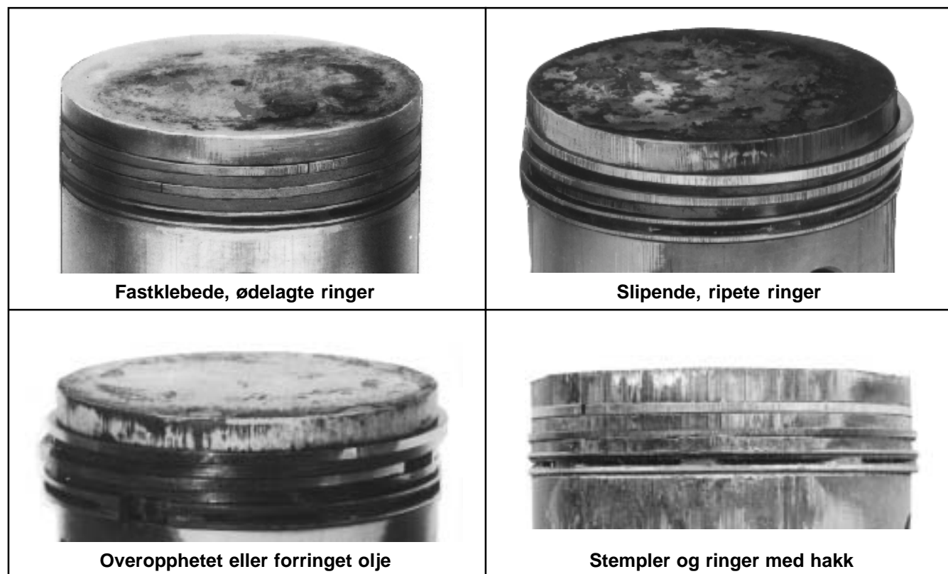
Figur 9-12. Vanlige skader på stempel og ring.
