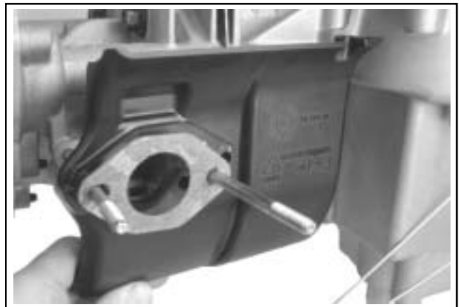
Figur 8-19. Ta av varmeavviseren.
