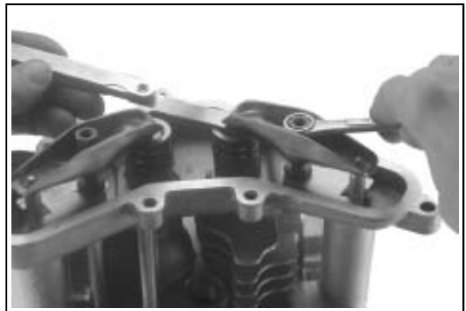
Figur 10-39. Justere ventilklaring (slag).
