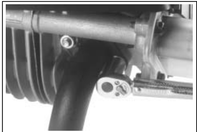
Figur 10-78. Trekke til eksosens flensmuttere.
