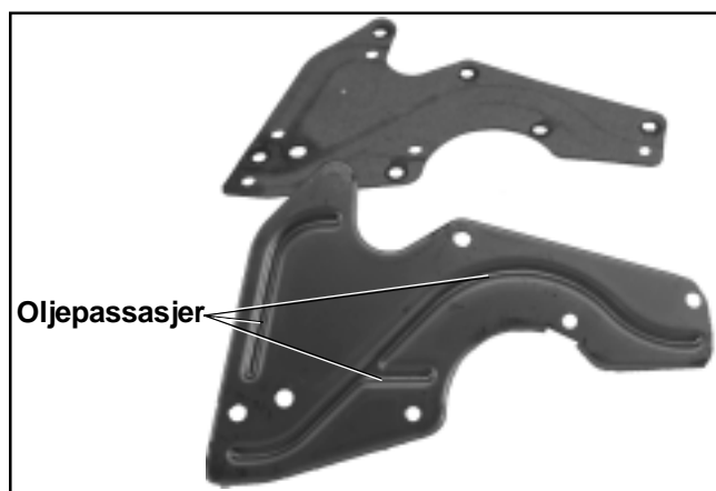
Figur 9-17. Oljepassasjer i passasjedeksel.
