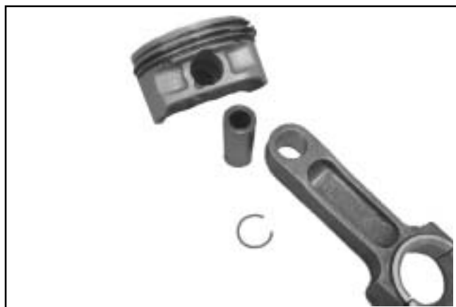
Figur 8-46. Skille stempelet fra stempelstangen.
