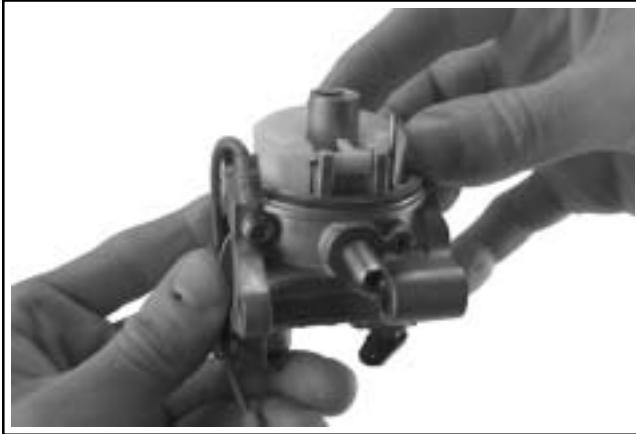
Figur 5-10. Installere flottør og drivstoffinntaksnål.
