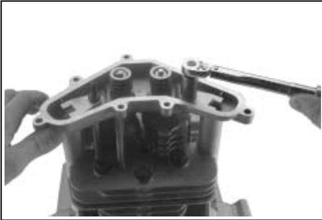
Figur 10-37. Installere føringsplater og ventilvippearmenes lagertapper.
