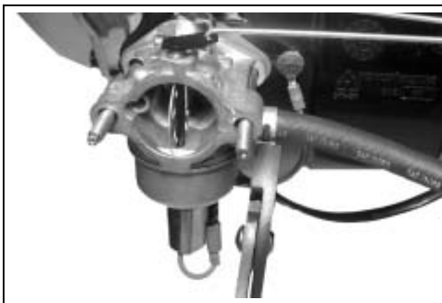
Figur 10-58. Kople drivstoffledningen til forgasseren.
