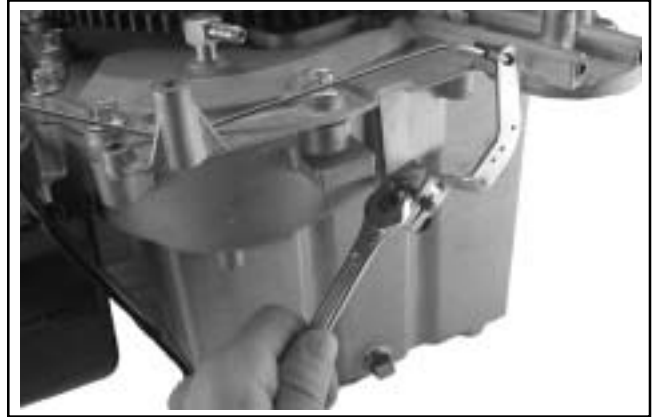
Figura 8-18. Desmontaje de la palanca del regulador.
