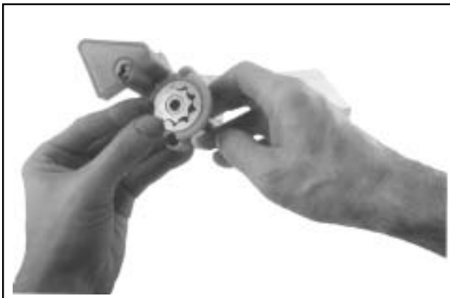
Figura 10-7. Engranajes del gerotor instalados en la bomba de aceite.
