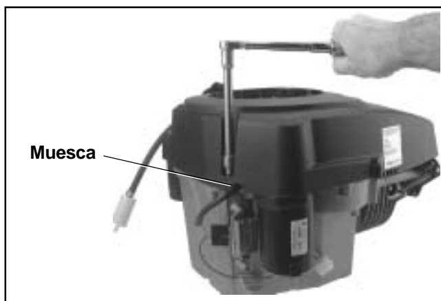
Figura 10-71. Instalación de los tornillos de la carcasa del ventilador.
