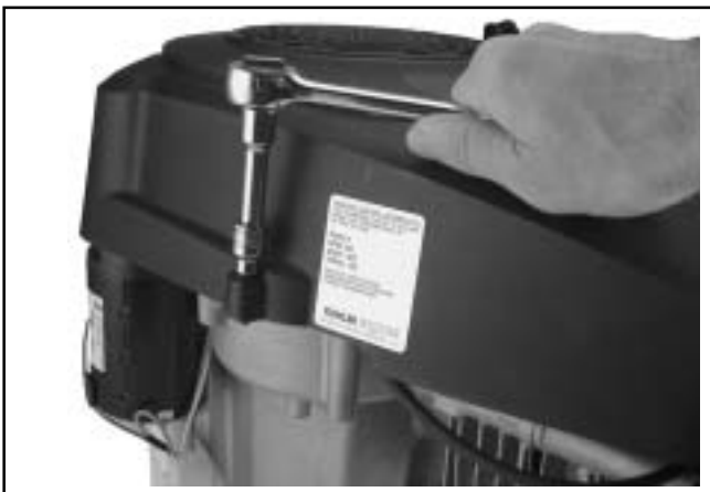
Figura 8-3. Extracción de los tornillos de la carcasa del ventilador.
