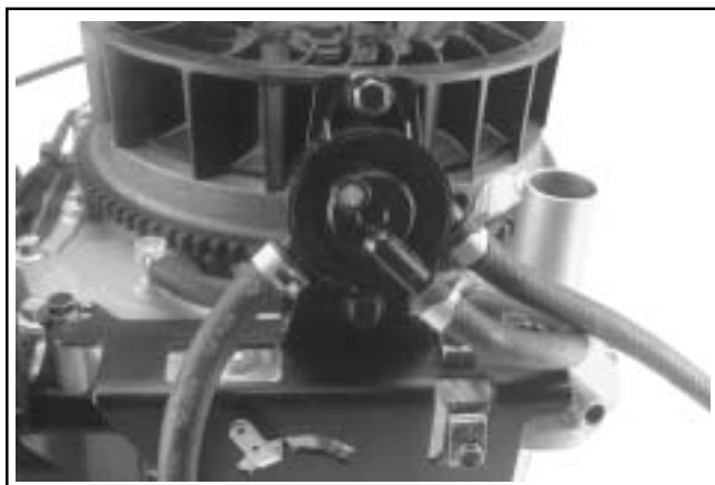
Figura 10-68. Instalación de la bomba de combustible.
