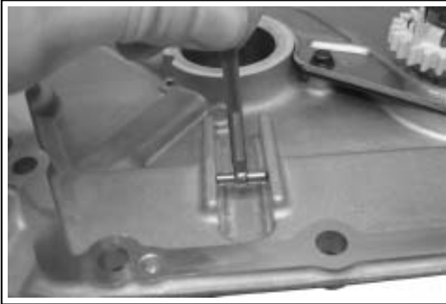
Figura 9-7. Medición del canal de guía de la placa de cierre.
