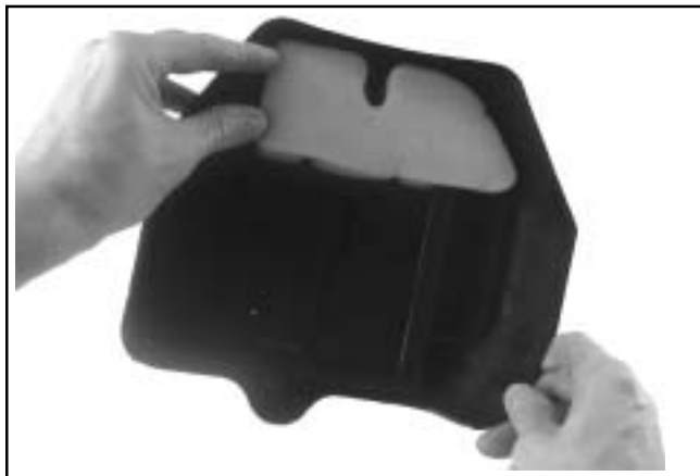
Figura 10-76. Instalación del filtro previo.
