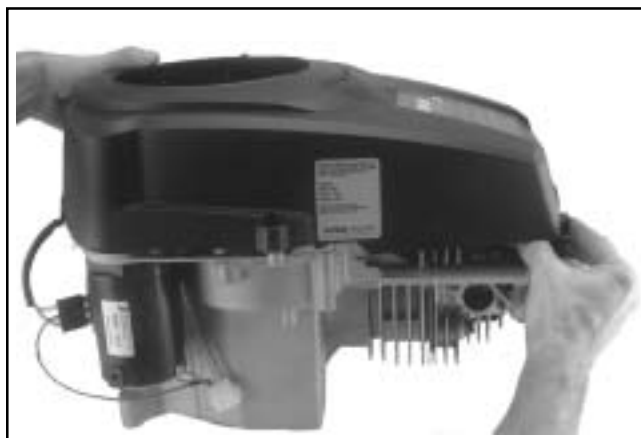
Figura 10-70. Instalación de la carcasa del ventilador.
