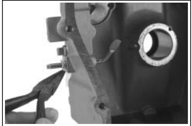
Figura 8-52. Extracción del pasador y la arandela.
