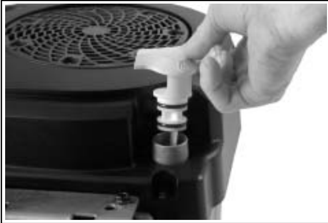
Figura 6-3. Extracción de la varilla de nivel.
