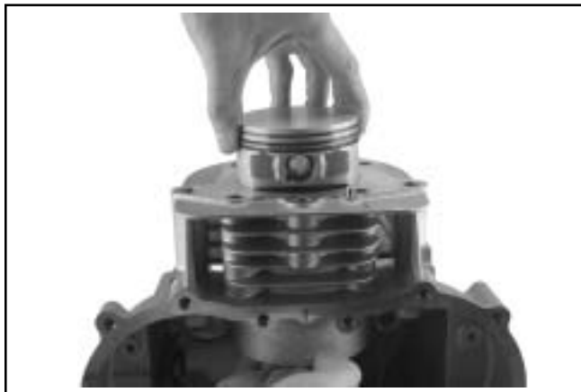
Figura 8-45. Desmontaje del sombrerete de la biela.
