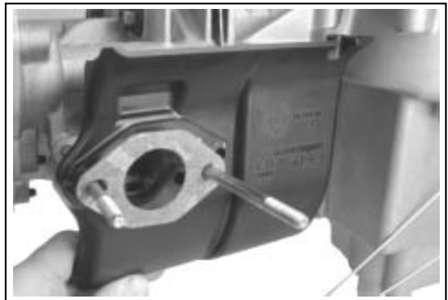
Figura 8-19. Desmontaje del deflector de calor.
