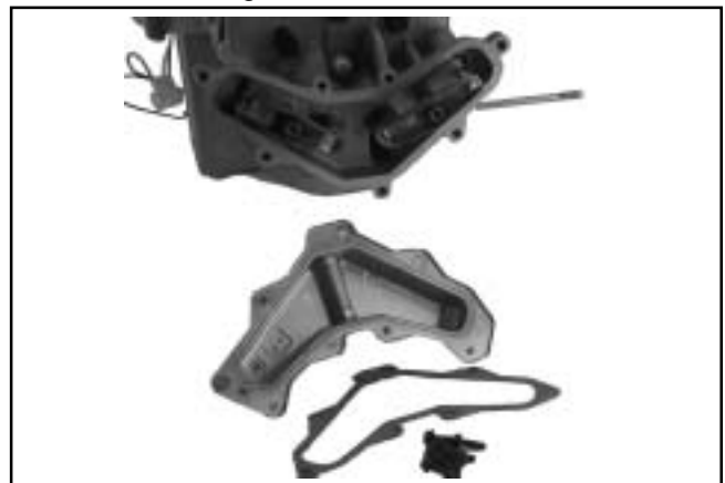
Figura 8-27. Vista detallada de la tapa y la junta de la válvula.
