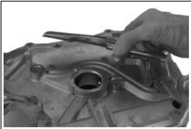
Figura 8-38. Desmontaje de la tapa y la junta del conducto de aceite.
