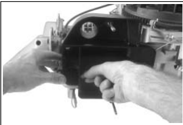
Figura 10-61. Instalación del tornillo de montaje. (Modelos con un perno y un tornillo).
