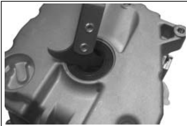
Figura 8-54. Desmontaje del sello con un extractor.
