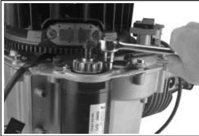
Figura 8-6. Desmontaje del motor de arranque eléctrico.
