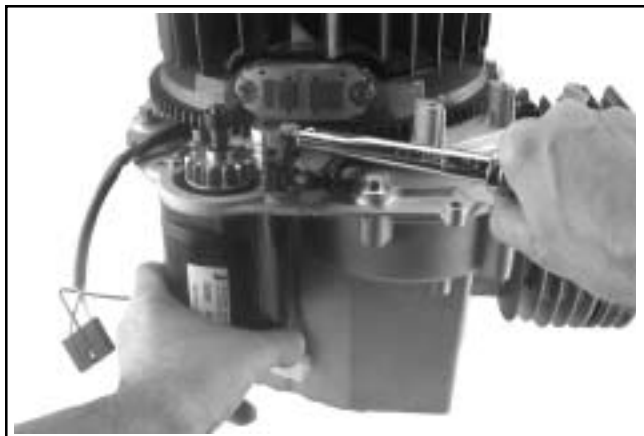
Figura 10-47. Instalación del motor de arranque eléctrico.
