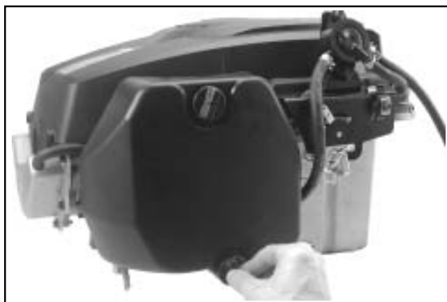
Figura 10-77. Instalación de la tapa del filtro.
