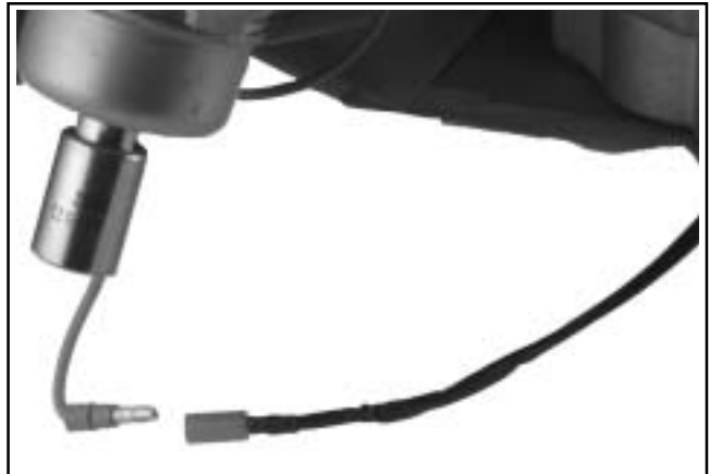
Figura 8-14. Desconexión del cable de la electroválvula de combustible.
