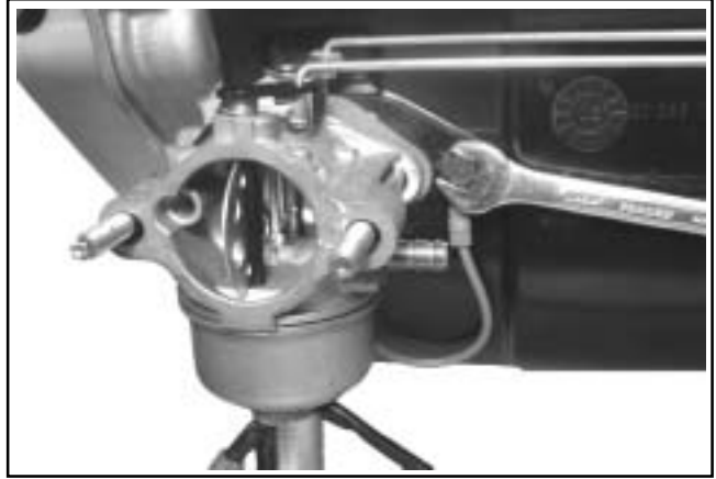
Figura 8-13. Desmontaje del tornillo del deflector de calor y del cable de masa.
