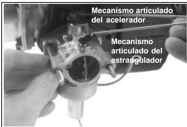
Figura 10-55. Instalación del conjunto del carburador con sus mecanismos articulados.
