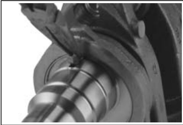
Figura 8-49. Extracción de la chaveta del engranaje de transmisión.
