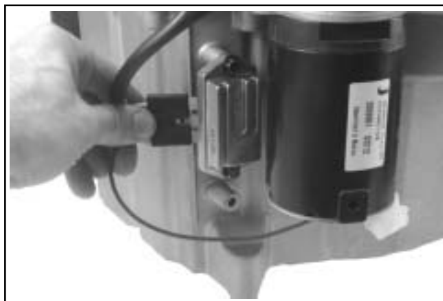
Figura 10-69. Instalación del rectificador-regulador.
