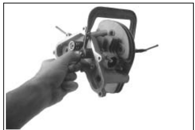
Figura 10-32. Montaje de la culata.
