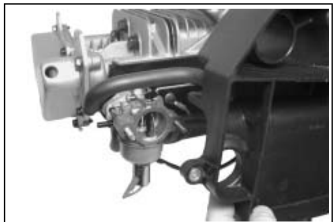
Figura 8-10. Desmontaje del soporte del filtro de aire y del tubo del respirador.
