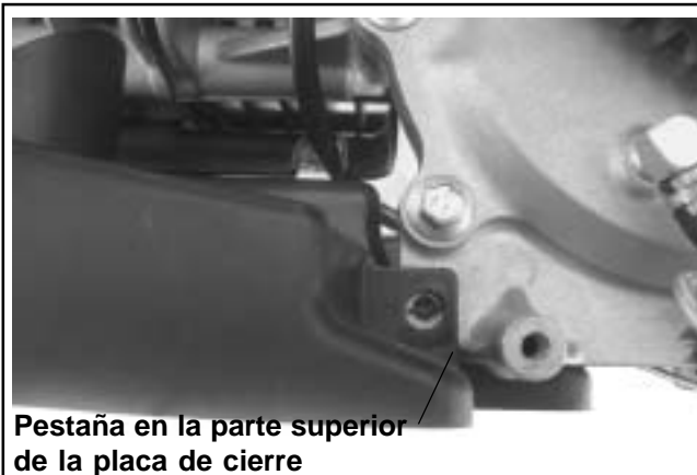
Figura 10-59. Detalle de la pestaña de montaje superior del soporte del filtro de aire.
