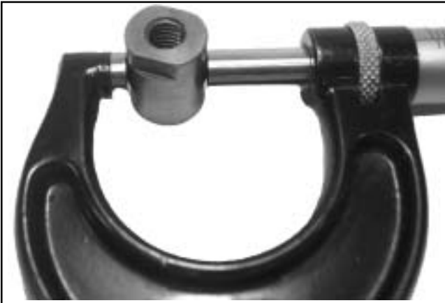
Figura 9-8. Medición del D.E. del pasador de guía.
