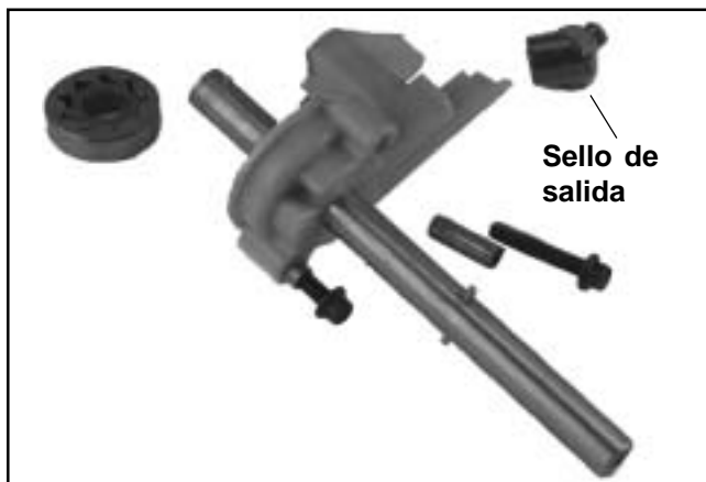
Figura 8-42. Árbol de levas de admisión y conjunto de la bomba de aceite.
