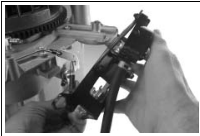
Figura 8-17. Desconexión del resorte del regulador.
