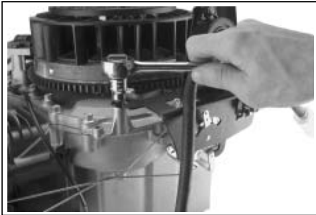
Figura 8-16. Desmontaje del soporte del control de velocidad de la placa de cierre.
