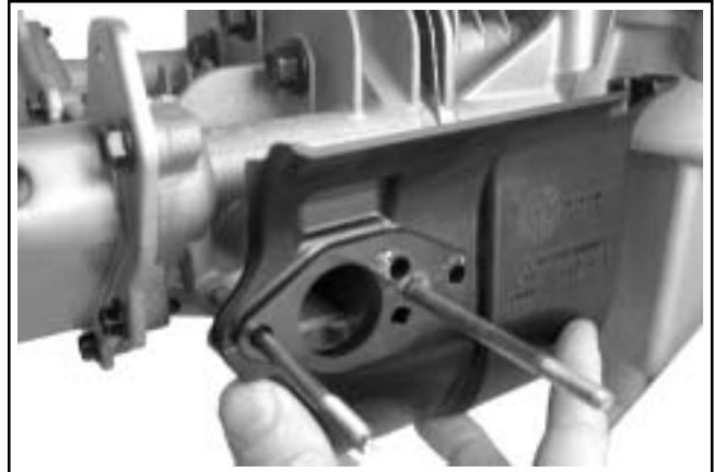
Figura 10-53. Instalación de la junta de admisión y el deflector de calor.
