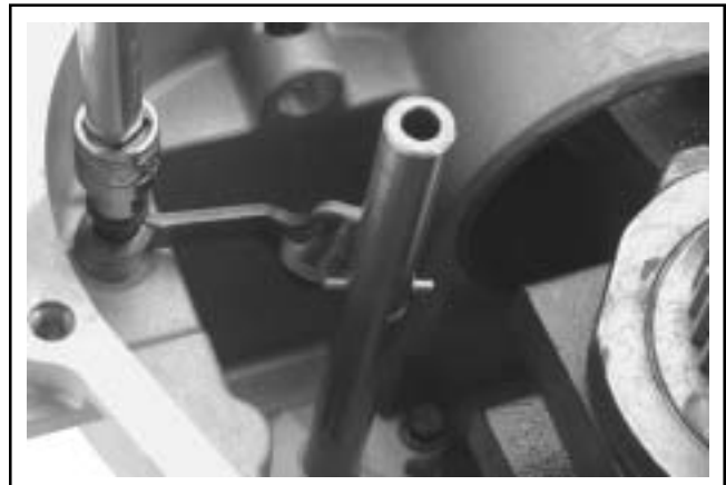
Figura 8-40. Desmontaje de las palancas de leva.
