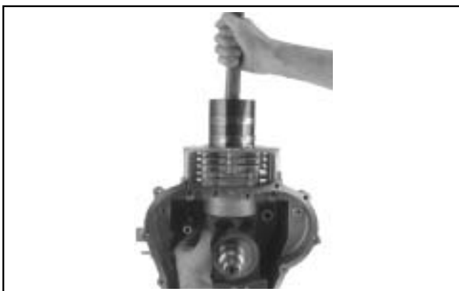
Figura 10-18. Instalación del pistón y la biela.
