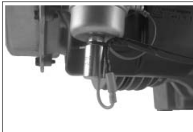
Figura 10-57. Sujeción del cable de la electroválvula de combustible con una brida de plástico.
