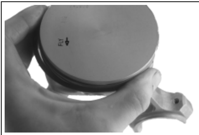
Figura 10-17. Flecha de dirección del pistón.
