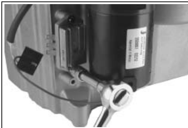
Figura 8-5. Desmontaje del rectificador-regulador.
