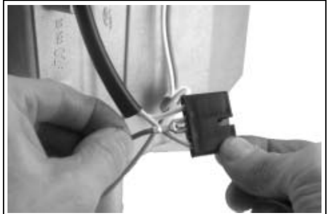
Figura 10-43. Instalación del cable B+ en el conector.
