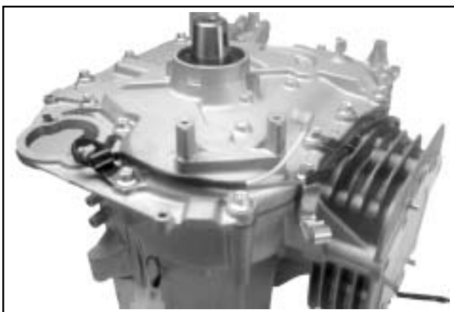
Figura 10-30. Placa de cierre instalada.
