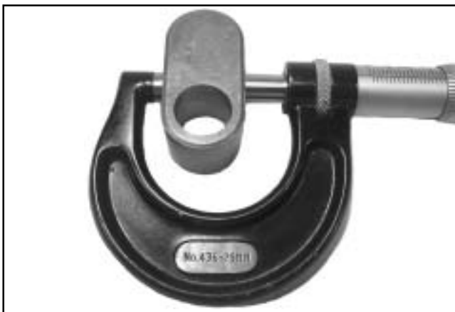
Figura 9-6. Medición del patín del contrapeso.
