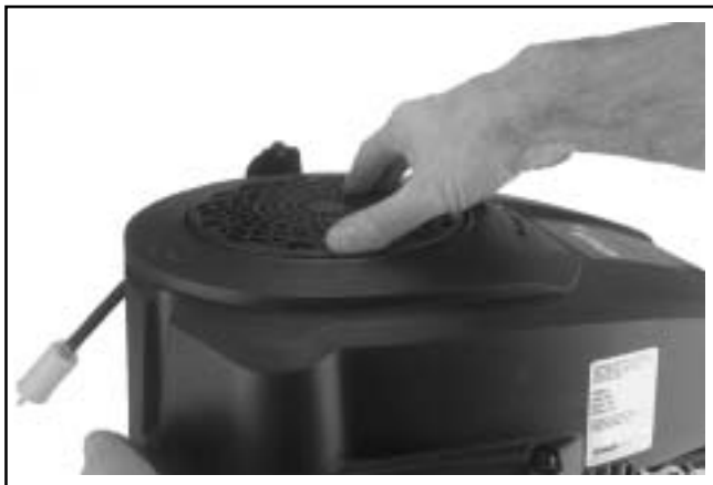
Figura 10-72. Instalación del tornillo de montaje.
