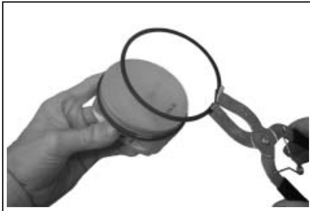
Figura 8-47. Desmontaje de los segmentos.
