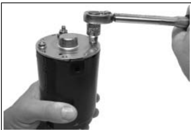
Figura 7-22. Apriete de los tornillos pasantes.
