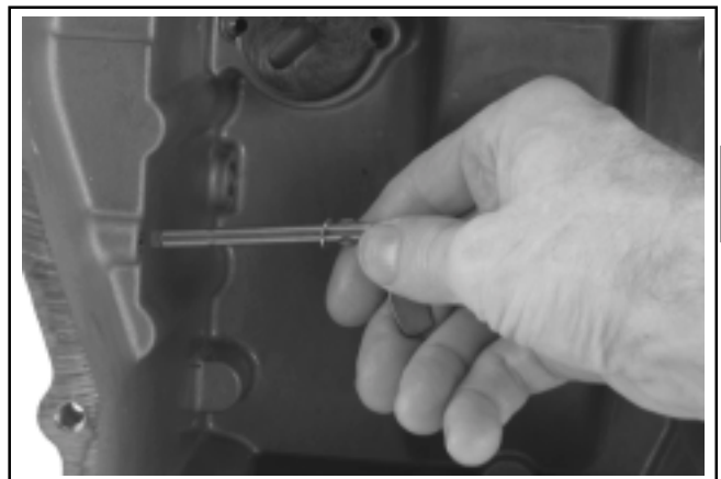
Figura 8-53. Extracción del eje transversal del regulador.
