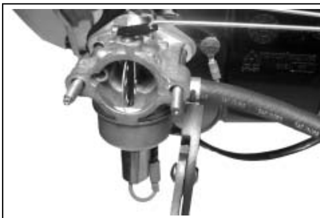
Figura 10-58. Conexión de la tubería de combustible al carburador.
