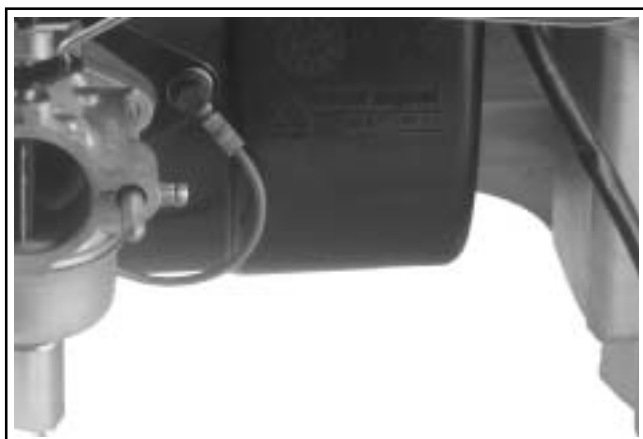
Figura 10-56. Sujeción del cable de masa.
