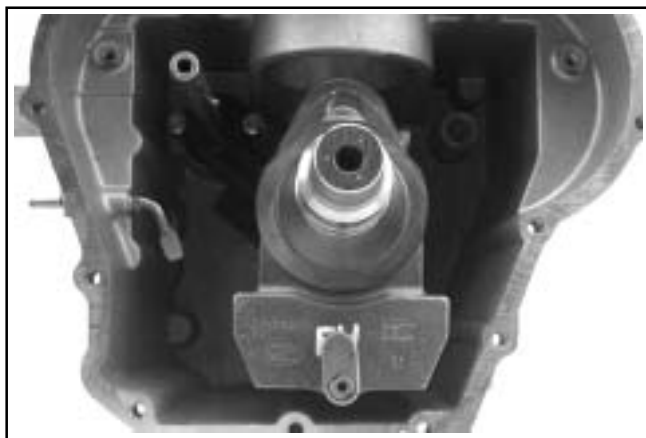
Figura 10-15. Instalación del patín.
