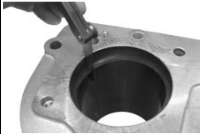
Figura 9-13. Medición de la abertura del segmento.
