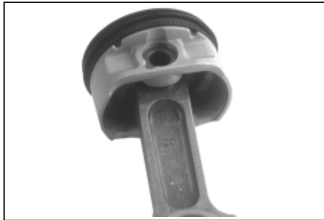
Figura 10-16. Pistón y biela montados.
