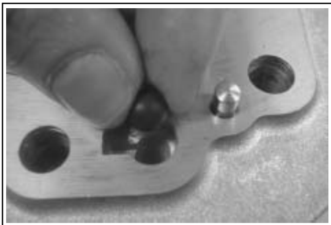
Figura 10-33. Instalación de la bola antirretorno.
