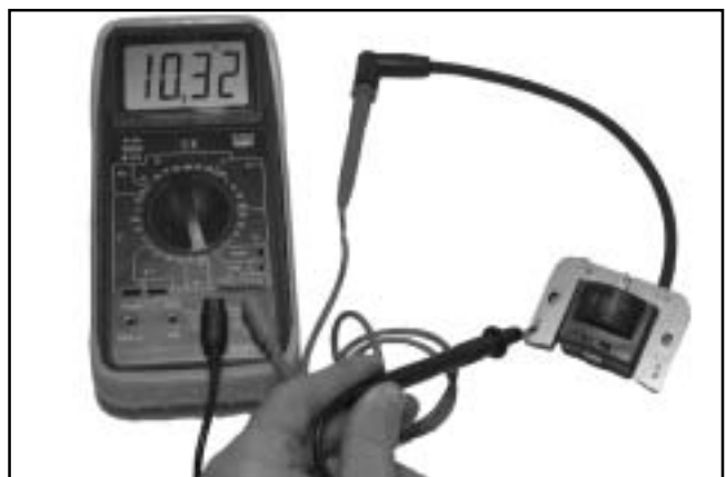
Figura 7-5. Prueba del módulo de encendido CDI secundario.
