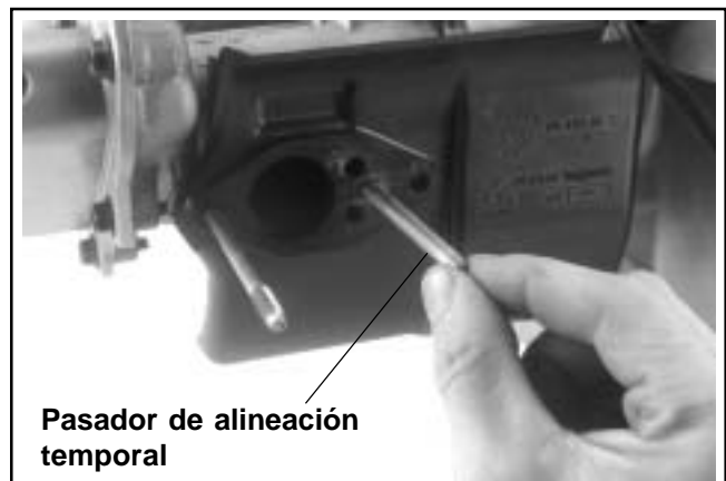
Figura 10-54. Inserción del pasador de alineación.
