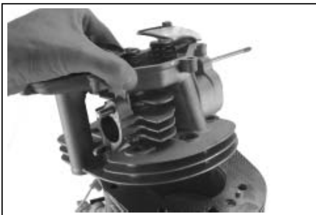
Figura 8-30. Desmontaje de la culata y la junta de la culata.
