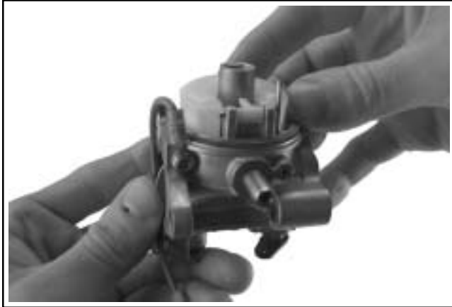
Figura 5-10. Instalación del flotador y de la aguja de admisión de combustible.
