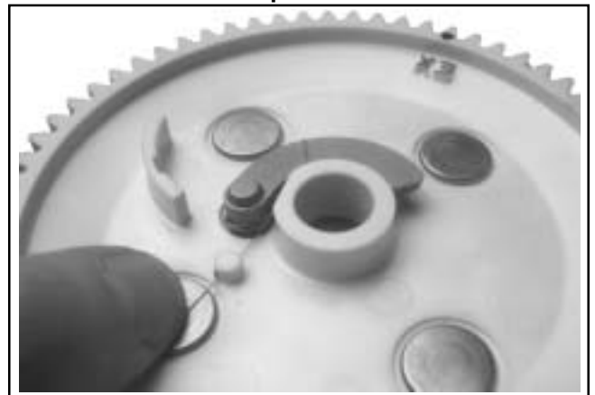
Figura 10-24. Enganche del resorte en el engranaje de leva de escape.
