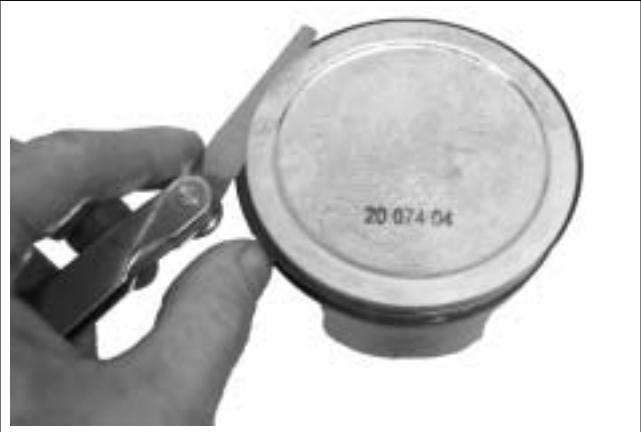
Figura 9-14. Medición del juego lateral del segmento.
