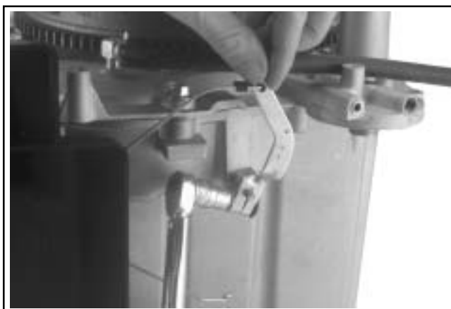
Figura 5-22. Apriete de la tuerca de la palanca del regulador.
