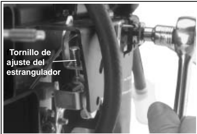
Figura 5-13. Ajuste del control de acelerador y estrangulador unificado
