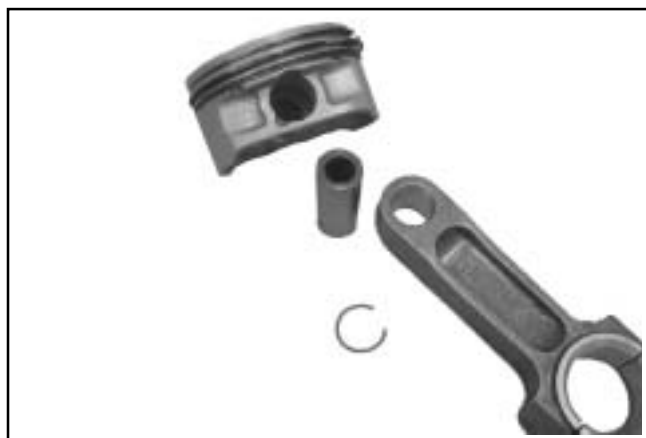
Figura 8-46. Separación del pistón y la biela.
