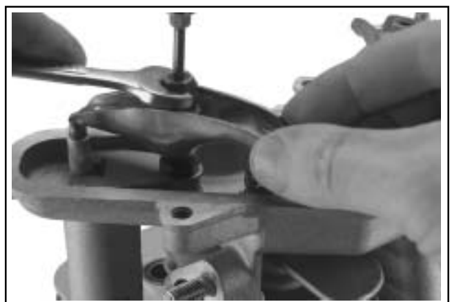
Figura 8-28. Extracción del tornillo de ajuste y la tuerca.
