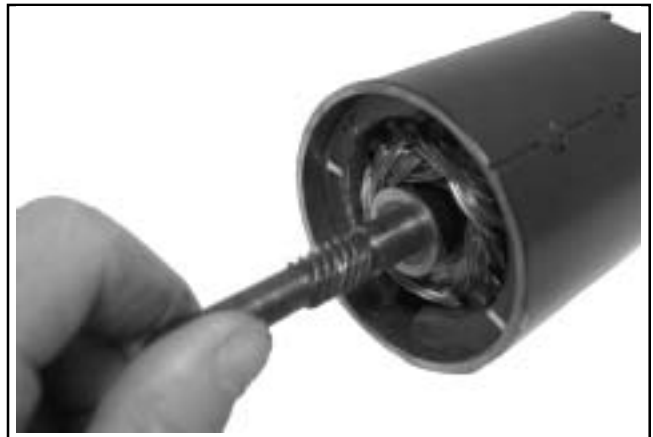
Figura 7-19. Inducido montado en el bastidor del motor de arranque.
