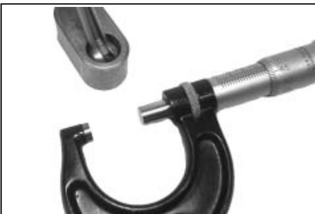
Figura 9-9. Medición del D.I. del orificio del patín.
