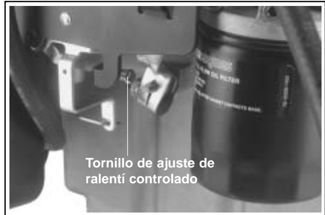
Figura 5-19. Situación del tornillo de ajuste de ralentí controlado.
