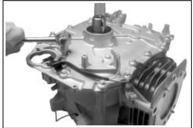
Figura 8-35. Desmontaje de los tornillos de la placa de cierre.
