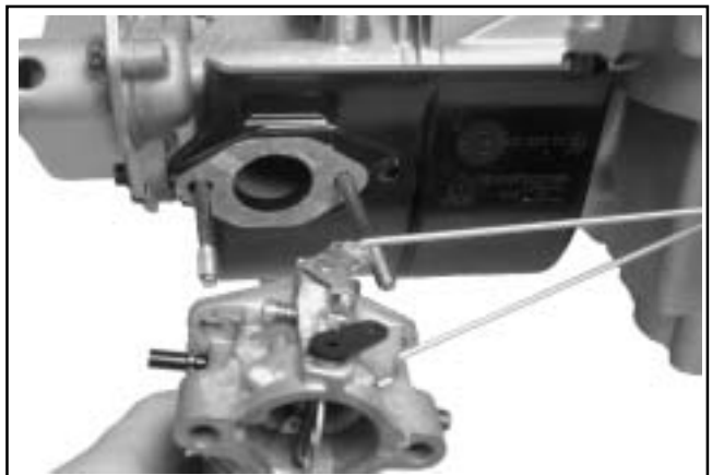
Figura 8-15. Extracción del carburador.
