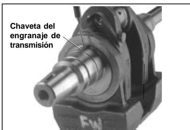
Figura 10-13. Instalación de la chaveta del engranaje de transmisión.
