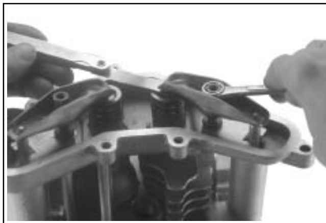
Figura 10-39. Ajuste del juego de la válvula.
