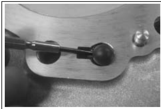
Figura 8-31. Desmontaje de la esfera antirretorno del cárter.
