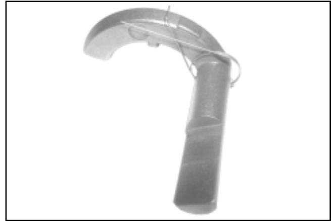
Figura 10-23. Resorte instalado en el contrapeso del sistema de descompresión automática.
